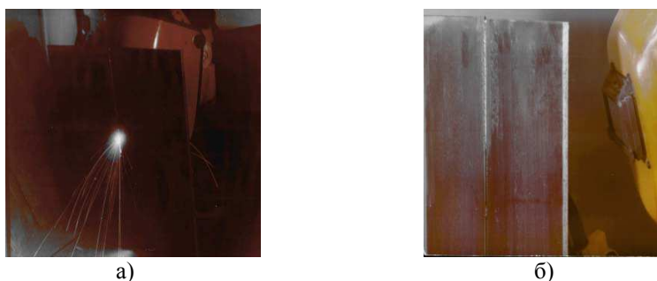
Рис. 4. Фрагмент вертикальной адаптивной импульсно-дуговой сварки корневого шва способом сверху – вниз судовых конструкций в \text{CO}_2 с переносом электродного металла во время принудительных коротких замыканий дугового промежутка (а) и внешний вид корневого шва с обратной стороны (б)
