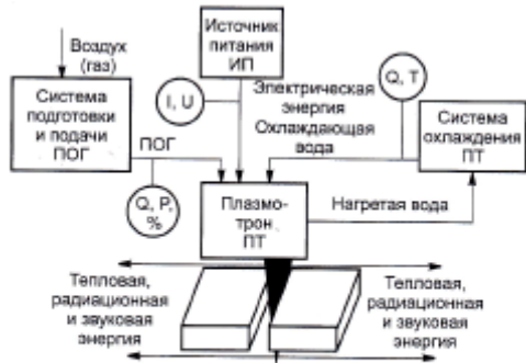
Рис. 2. Материально-энергетическая схема плазменной резки металлов (ПТ — плазматрон; ИП — источник питания, датчики контроля; I — ток; U — напряжение; Q — расход; P — давление; T — температура, % — состав)
