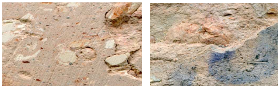
Рис. 2. Образцы состава «суглинок-шлак» после обжига
