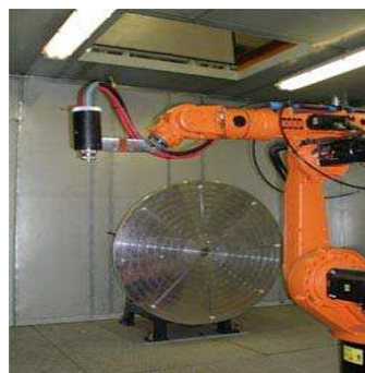
Рис. 2. Установка для плазменного напыления ТСЗП-MF-P-1000 (плазматрон F4 с манипулятором)
