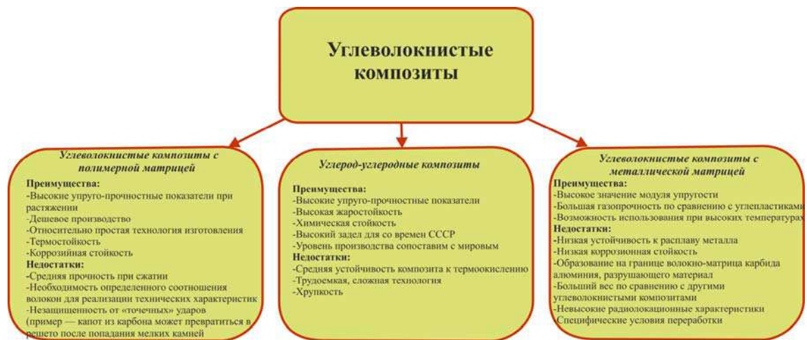
Рис. 1. Виды углеволокнистых композитов
