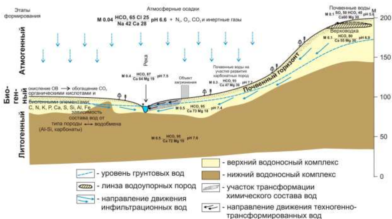
Рис. 7.8. Схема формирования химического состава подземных вод
