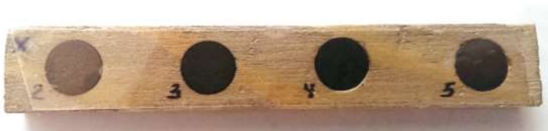
Рисунок 2.7 – Общий вид подготовленных к осколочной радиографии образцов накипи питьевых вод
