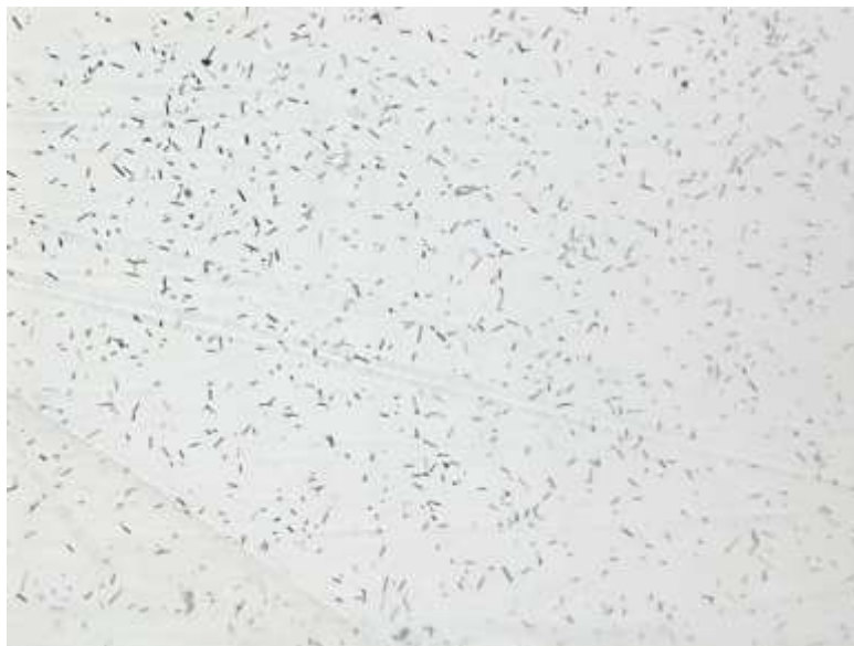
Рисунок 6.9 – Равномерный характер распределения U в накипи природных пресных вод (содержание элемента – 1,8 мг/кг). Детектор – слюда. Увеличение – 120x
