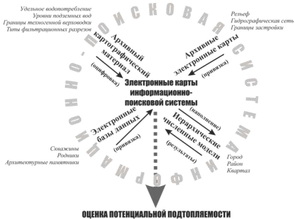
Рис. 5.1. Структурная схема информационно-поисковой системы
