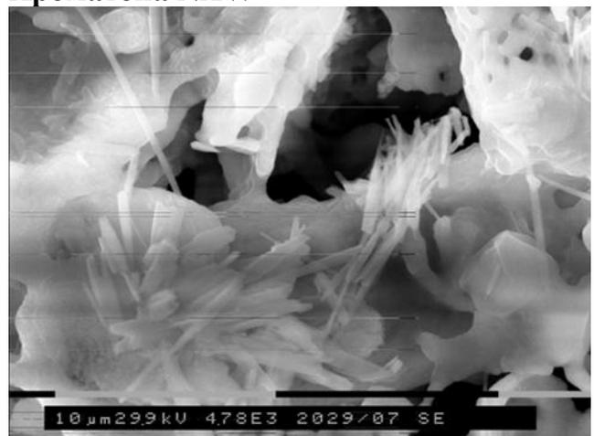
Рисунок 2.4– Поверхность Хроматона NAW, модифицированного 5 % Cu(acac)<sub>2</sub>
