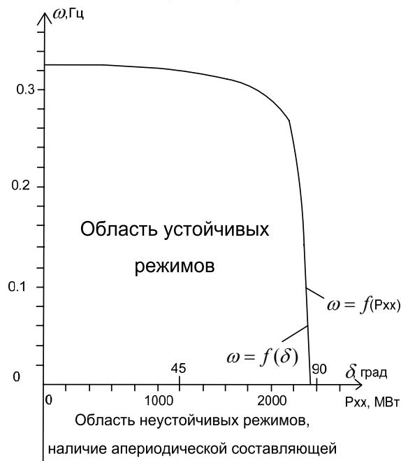
Рис. 2. Влияние загрузки межсистемной связи Сибирь – Казахстан (XX сечения) P_{xx} и взаимного угла между эквивалентными генераторами Сибири и Казахстана \delta на первую гармонику частоты собственных колебаний
