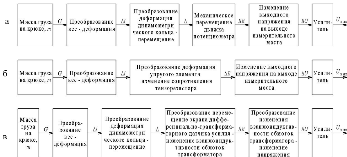
Рис. 2. Датчики измерения усилия традиционного типа: а) потенциметрический; б) тензометрический; в) дифференциально-трансформаторный. Обозначения: G – вес груза; \Delta l – деформация; \Delta – механическое перемещение; \Delta R – изменение активного сопротивления; \Delta U – изменение напряжения; \Delta M – изменение взаимной индуктивности обмоток трансформатора; U_{\text{вых}} – напряжение выходного сигнала датчика
