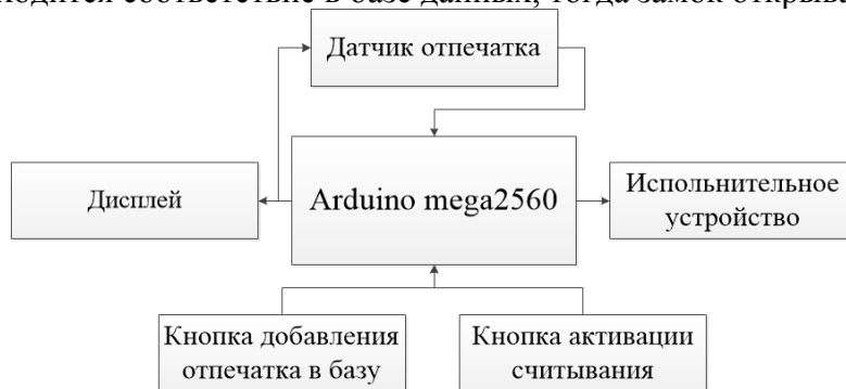
Рис. 2. Схематическое устройство Touch Lock
