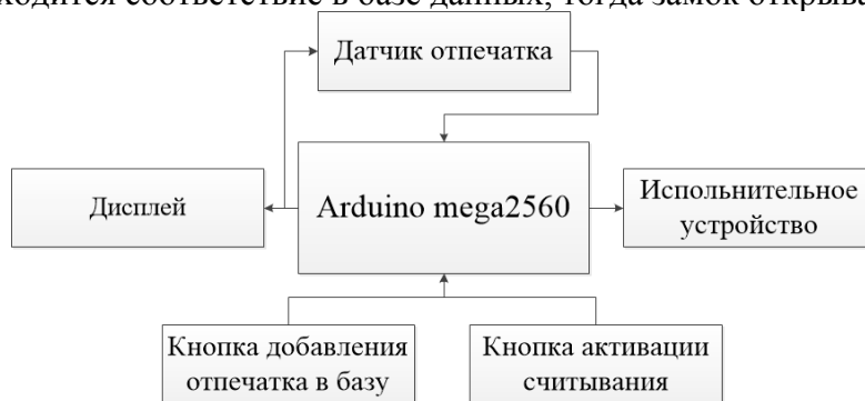
Рис. 2. Схематическое устройство Touch Lock
