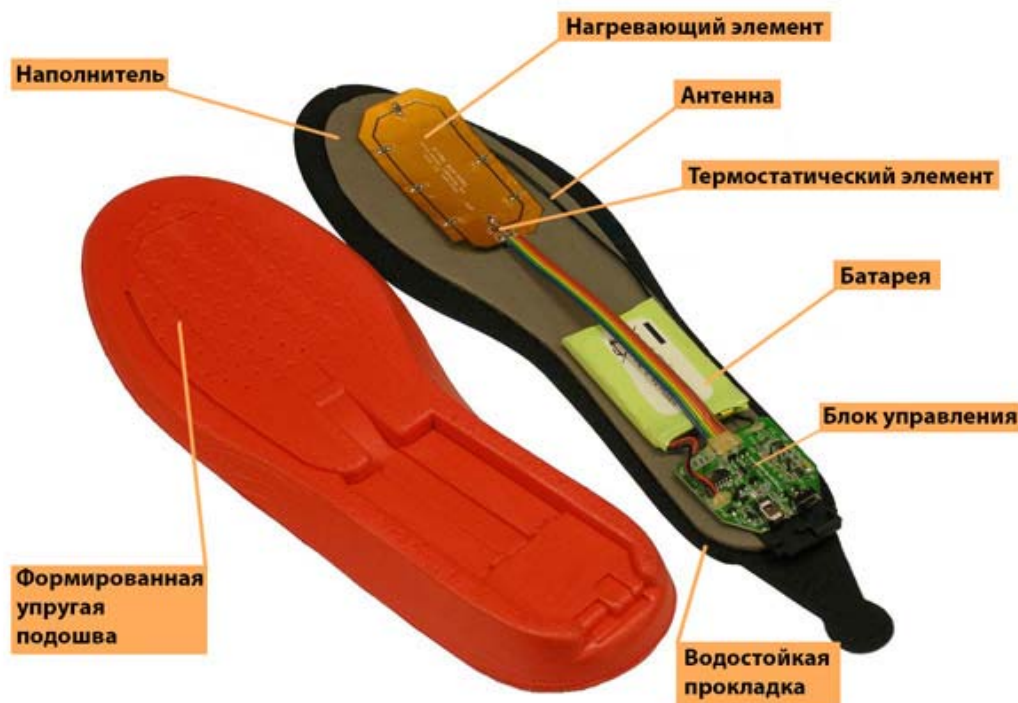
Рисунок 1. Схема стельки с подогревом
