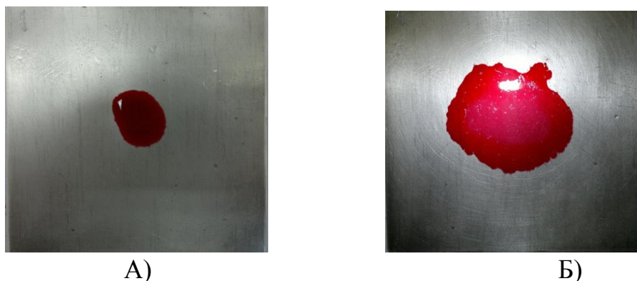
Рисунок 2. Размеры пятен пенетрантов на поверхности дюралюминия через 4 минуты после нанесения. А)-пластина обработана пенетрантом SHERWIN DP-51; Б)-пенетрантом BYCOTEST RP20LT.
