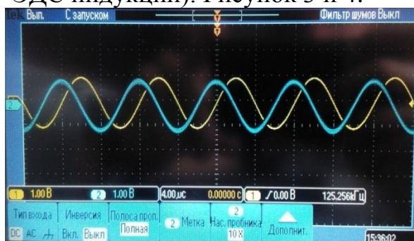
Рисунок 3 – Сравнение по фазе акустического сигнала и сигнала ЭДС индукции магнитоупругого эффекта.
