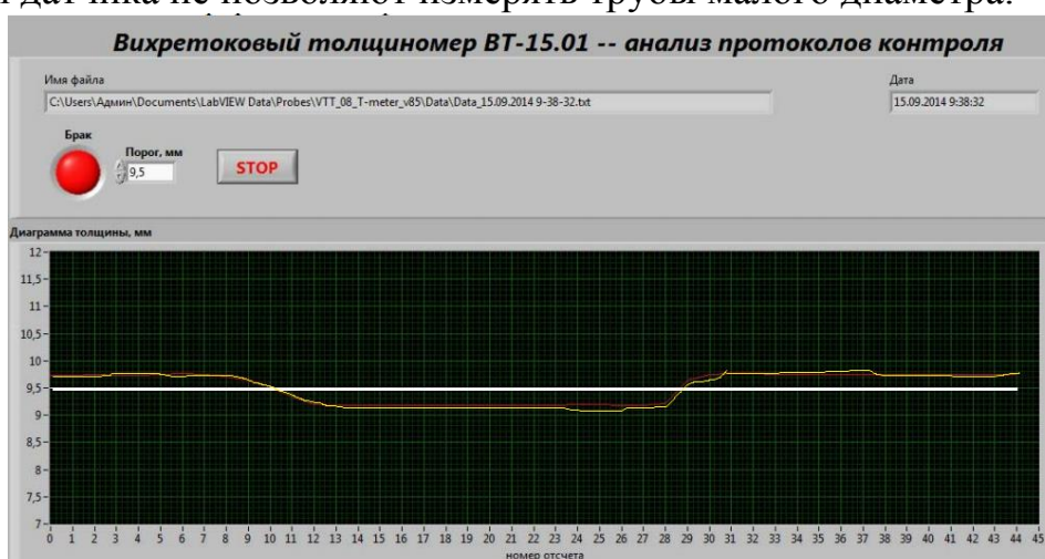
Рисунок 5 Пример результатов измерения толщины стенки трубы
