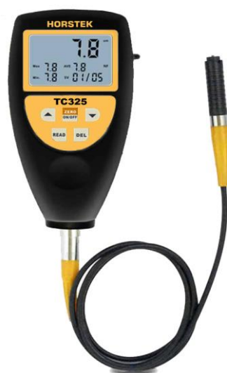
Рис. 2. Магнитный толщиномер Horstek TC 325
