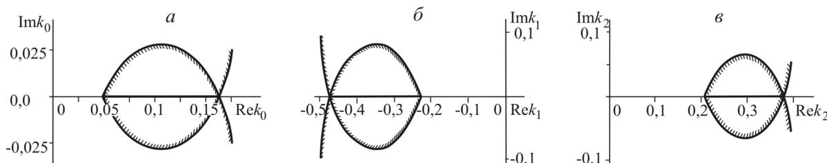
Рис. 2. Области допустимых изменений параметров регулятора для: а)  $k_0$ , б)  $k_1$ , в)  $k_2$
