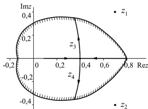
Рис. 3. Расположение полюсов замкнутой системы, рассматриваемой в Примере 1
