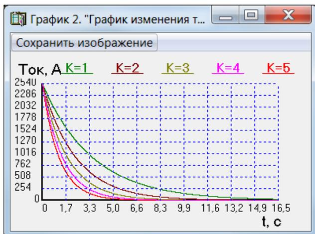
Рис. 4. Пример построения графика при замыкании обмотки возбуждения на резистор
