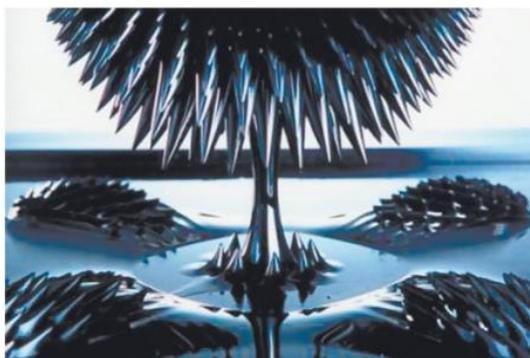
*Рис. 1. Поведение магнитной жидкости в магнитном поле [1]*
