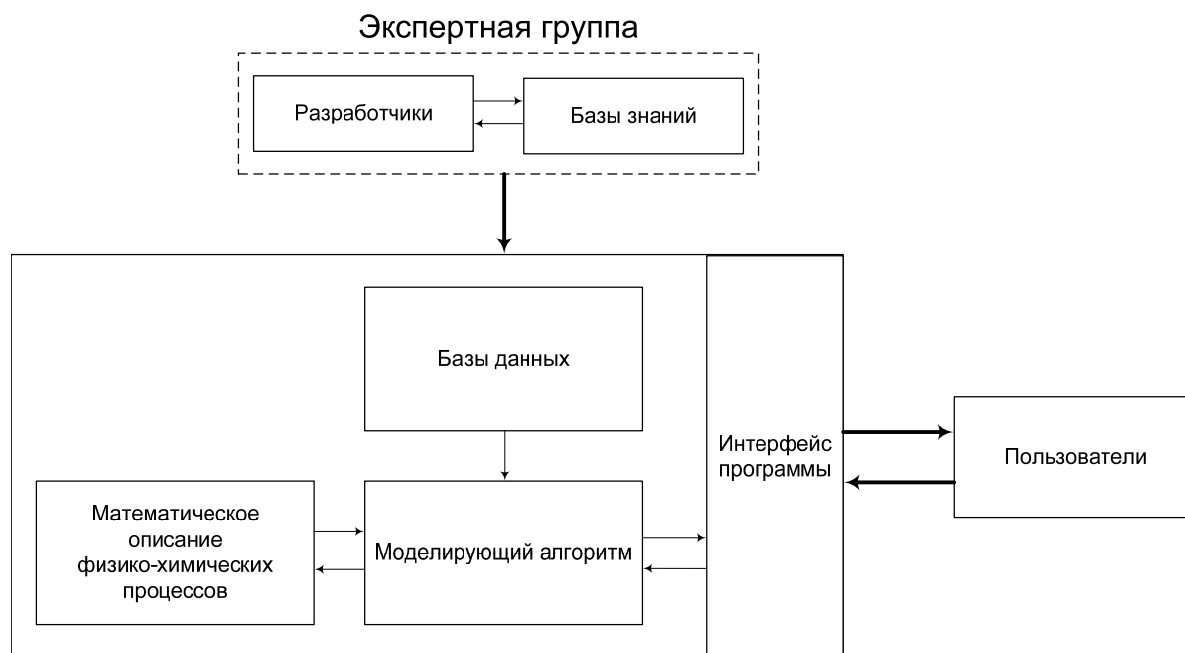
Рис. 5. Схема взаимодействия модуля КМС с пользователями
