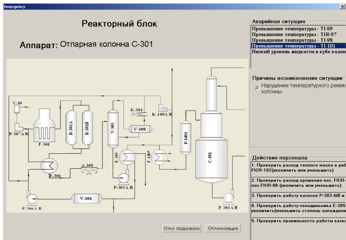
Рис. 7. Продукционно-фреймовая модель для определения аварийных ситуаций
