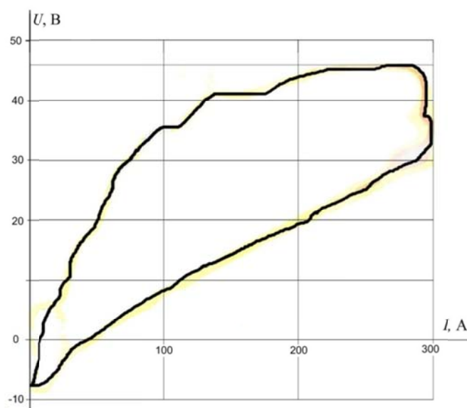
Рис. 5. Динамическая характеристика дуги в аргоне
