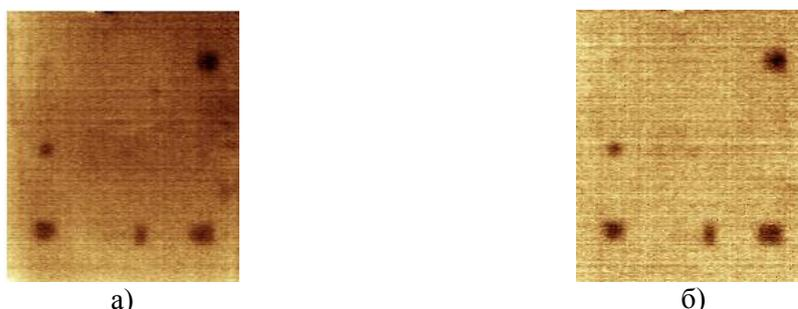
**Рис. 5.** Применение метода главных компонент к последовательности термограмм первого эксперимента, а) 1-я компонента, б) 2-я компонента
