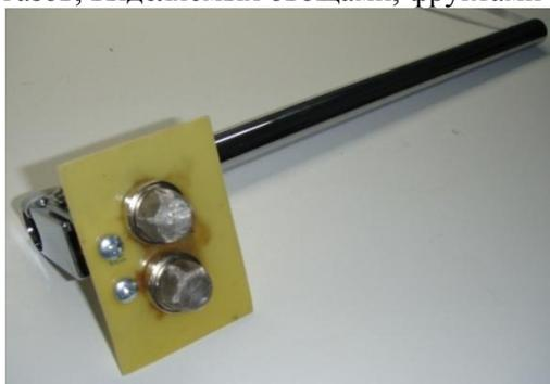
**Рис.1** Экспериментальный газоанализатор, первый прототип
