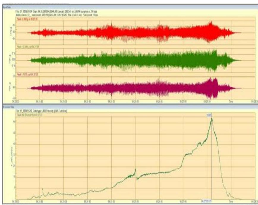
**Рис.5 .** Запись интенсивности (балльности) колебаний виброплатформы на модели дома из «глинобита», 07 июля 2014г. Ускорение -  $60 \text{ см/с}^2$
