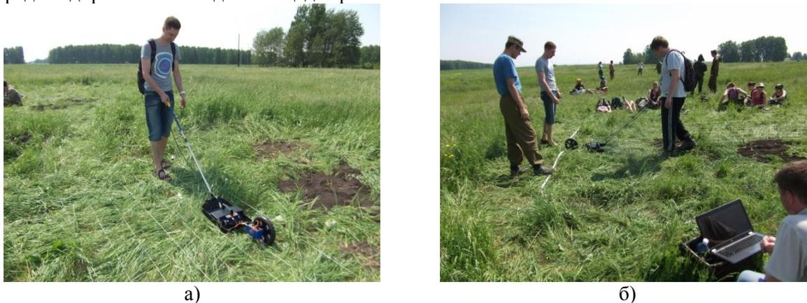
**Рис. 1.** Георадарные измерения среды обитания цокора
