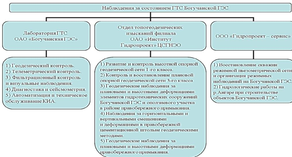
Рис. 1. Схема мониторинга за состоянием ГТС Богучанской ГЭС
