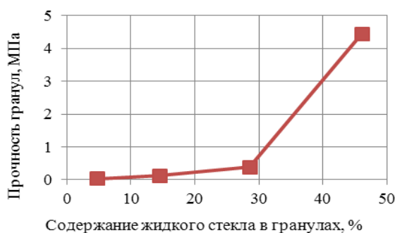
Рис. 2. Зависимость прочности гранул от содержания связующей жидкости
