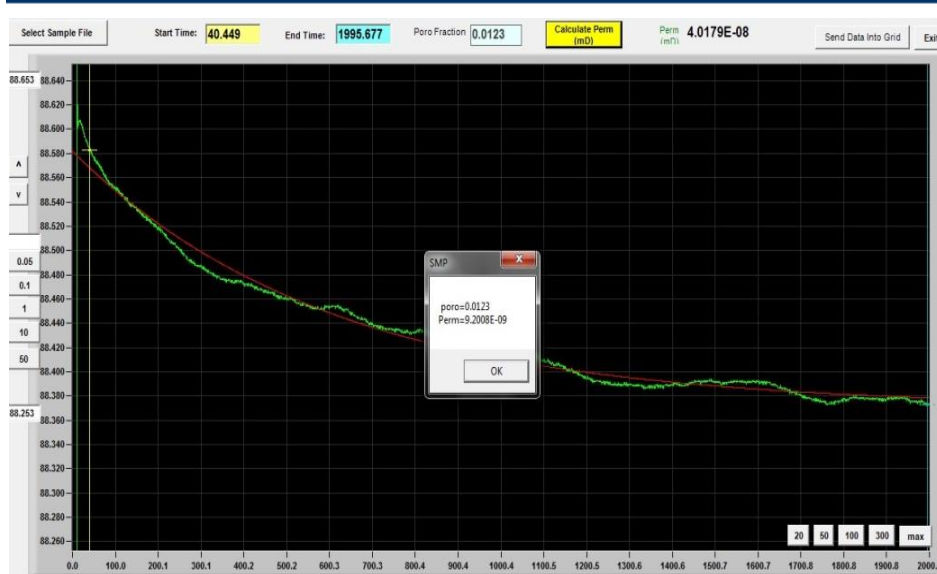
Рис.2 Расчет проницаемости кремнисто-глинистого образца с размером фракции 1 – 2 мм
