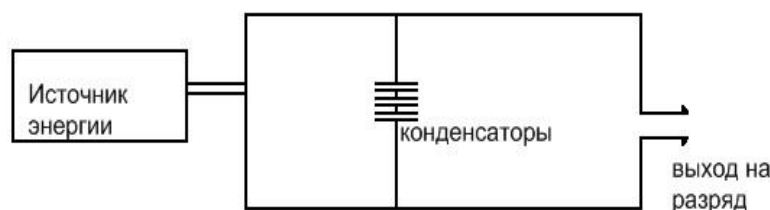
Рис. 1 Схема установки плазменно-импульсного воздействия
