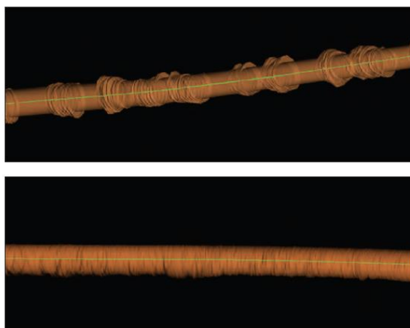
Рис. 1 Сравнение качества ствола скважины, построенного по данным каверномера: сверху – забойный двигатель с кривым переводником, снизу – роторная управляемая система [1]
