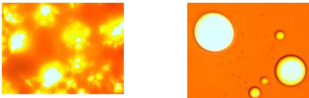
Рис. 1 Изображение, снятое при помощи микроскопа. Справа – ВНЭ без добавления щелочи. Слева – ВНЭ с 0,1% NaOH. Масштаб 1:0,00025
