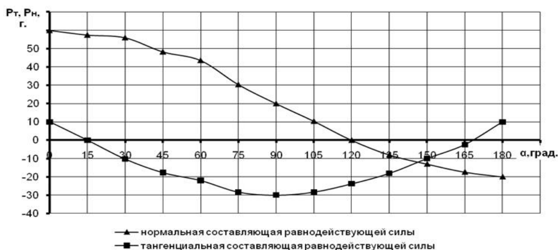
Рис. 2. Изменение нормальной ( P_n ) и тангенциальной ( P_t ) составляющих равнодействующей силы в зависимости от пространственного положения
