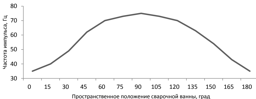
Рис. 3. График изменения частоты импульса в зависимости от пространственного положения сварочной ванны
