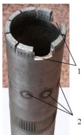
Рис. Опытная коронка КИТ: 1 – широкие промывочные каналы, полученные путем удаления двух алмазосодержащих секторов; 2 – наплавки для наблюдения за механизмом движения коронки при бурении
