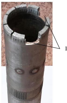
Рис. Опытная коронка для бурения анизотропных горных пород : 1 – широкие промывочные каналы, полученные путем удаления двух алмазосодержащих секторов
