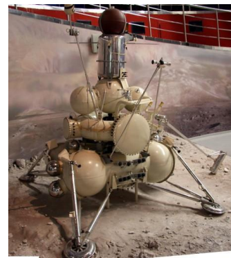
Автоматическая лунная станция «Луна-24» с турбобуром и заборным устройством для отбора лунного грунта, разработанные в ТПУ
