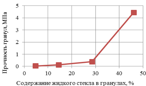
Рис. 2. Зависимость прочности гранул от содержания связующей жидкости
