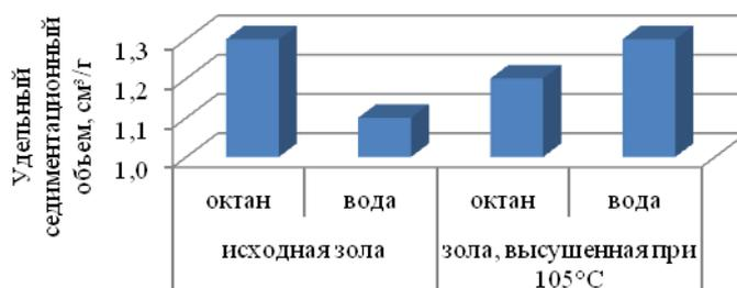
Рис. 2. Удельный седиментационный объем зола в жидкостях различной полярности
