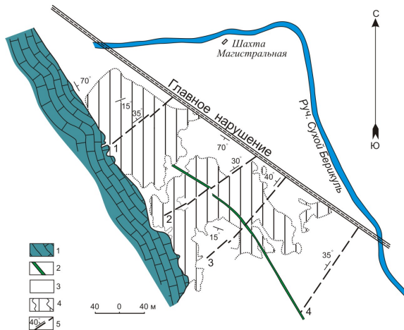
Рис. 5. Проекция жилы № 4 на горизонтальную плоскость. По А.П. Смолину, 1941 г. 1) известняки; 2) дайки долерита; 3) не отработанные участки жилы висячем боку Главного нарушения; 4) отработанные участки жилы; 5) линии сопряжения пологой жилы с крутопадающими: 1) Магистральной; 2) Кировской; 3) № 14, 4) № 21
