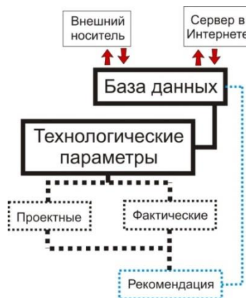
Рис. 1. Блок-схема стандартной системы интеллектуального контроля и управления процессом бурения
