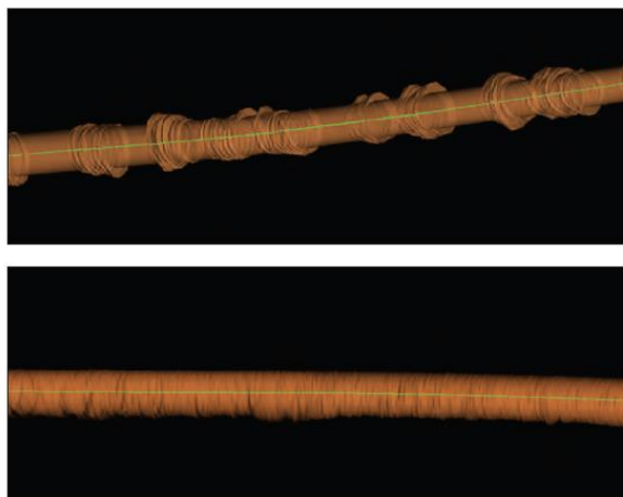
Рис. 1 Сравнение качества ствола скважины, построенного по данным каверномера: сверху – забойный двигатель с кривым переводником, снизу – роторная управляемая система [1]
