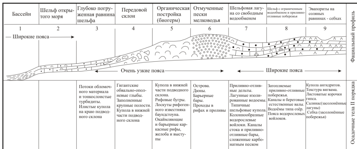
Рис. Схема стандартных фациальных поясов и фациальных тел второго порядка. По Дж. Л. Уилсону [4]
