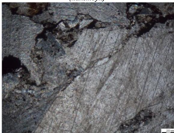
*Рис. 4. Известняк перекристаллизованный*
