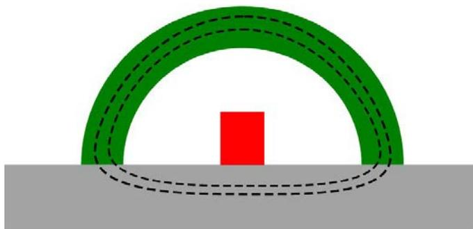
**Рис. 1. Общая схема чувствительного элемента установки магнитного метода неразрушающего контроля ферромагнитных материалов: зеленый – намагничиваемая скоба; красный – индуктивный датчик; серый – трубопровод**
