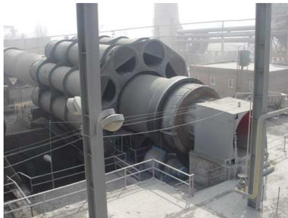
Рис. 2. Печь с рекуператорными холодильниками – вид сзади
