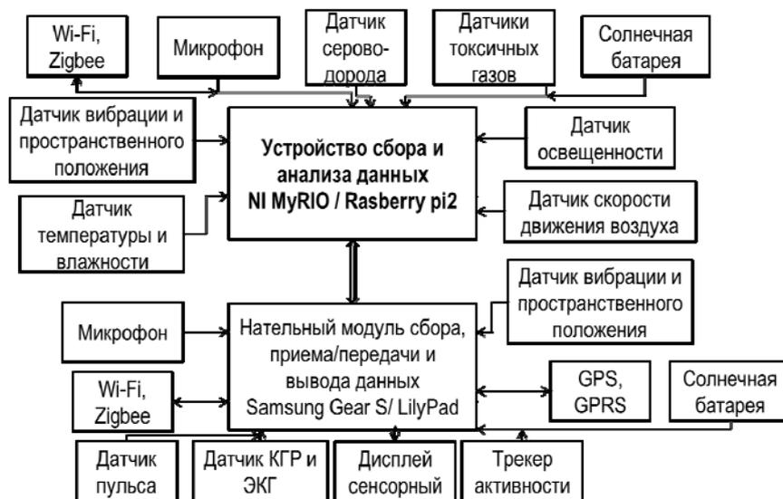
Рис. 1. Схема устройства многопараметрического мониторинга состояния человека
