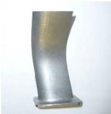
Рис. 1 Внешний вид лопатки, изготавливаемой с использованием кинематической схемы с вибрацией электродов
