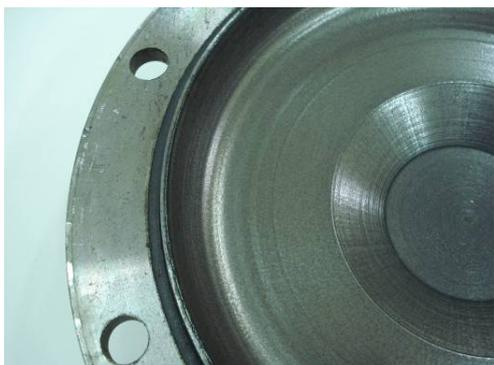
Рис. 6. Внутренняя поверхность корпуса устройства блокировки со следами скольжения шариков после работы с ведомым диском с выступами высотой 12 мм
