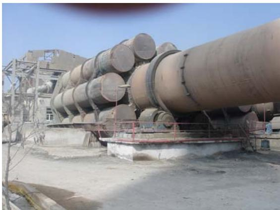
Рис. 1. Печь с рекуператорными холодильниками – вид спереди
