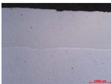
Рис. 1. Микрофотография поперечного шлифа образца системы Ti-Al
