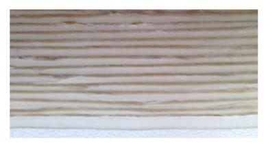
Рис. 3. Пример армированого арамидной нитью образца, напечатанного экструзионным методом
