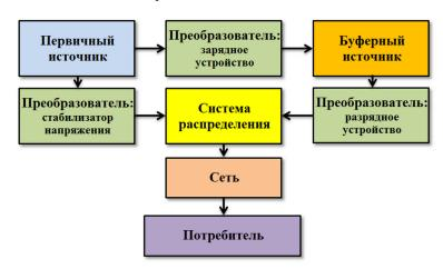
Рис. 1. Типовая структура системы электроснабжения КА
