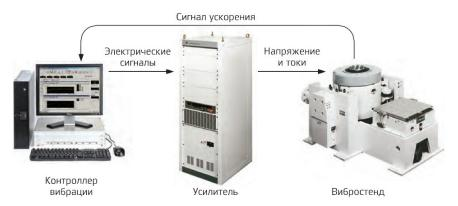
Рис. 1. Схема принципа действия вибростенда
