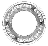
Puc. 3. Картина магнитного поля при нулевой скорости ротора
