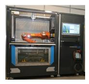
Рис. 1. Внешний вид автоматизированной ультразвуковой системы томографического контроля
