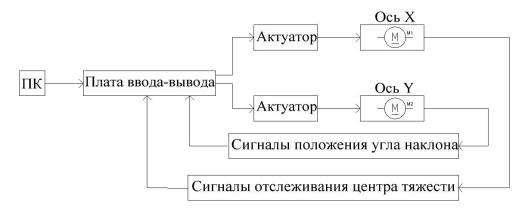
Рис. 4. Структурная схема стабилоплатформы
