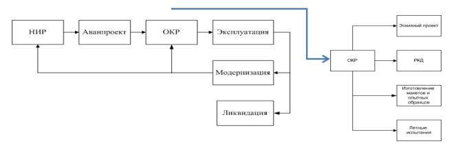
Рис. 1. Жизненный цикл космического аппарата
