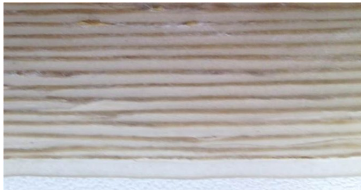
Рис. 3. Пример армированного арамидной нитью образца, напечатанного экструзионным методом
