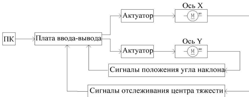
Рис. 4. Структурная схема стабилоплатформы
