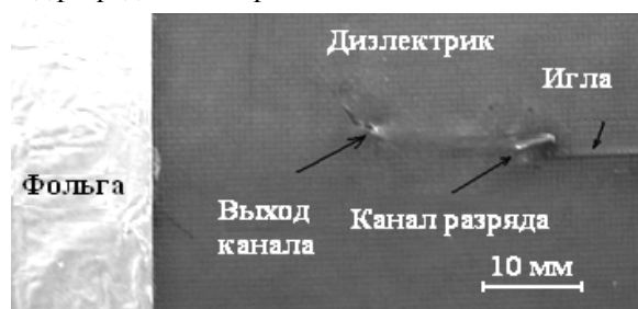
Рис. 5. Вид канала разряда в композиции ПММА – имидофлекс в системе электродов типа Б
