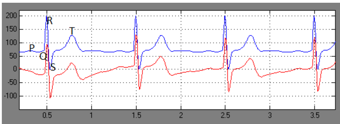
Рис. 7. Сравнение электрокардиограмм, исходной и отфильтрованной ФВЧ, ФНЧ и РФ типа Баттерворта 3 порядка
