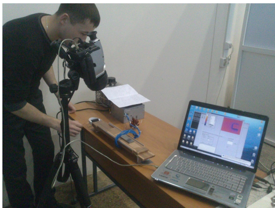
Рис. 4. Проведение индукционной инфракрасной термографии
