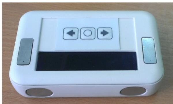
**Рис. 1.** Расположение электродов в корпусе
