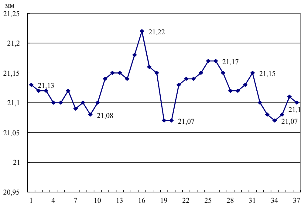
Рис.6. Экспериментальным путем измерения внутреннего диаметра трубы 21 мм
