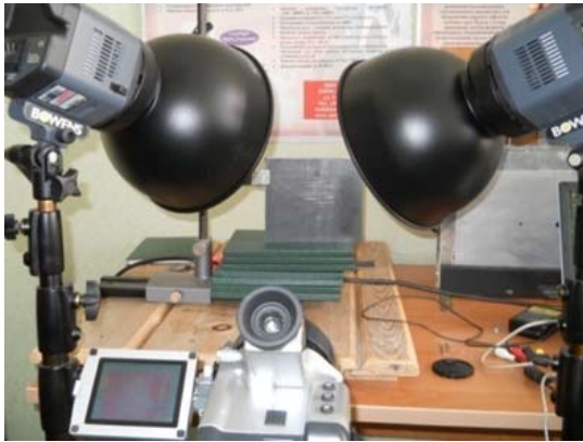
Рис. 2. Лабораторная установка, использующая ксеноновые импульсные лампы
