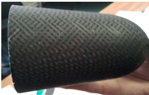
Рис. 2. Наконечник из углерод – углеродного материала
