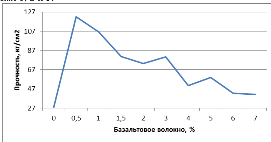
Рис 1. Зависимость прочности сжатию ангидритовых образцов от содержания наполнителя – базальтовое волокно
