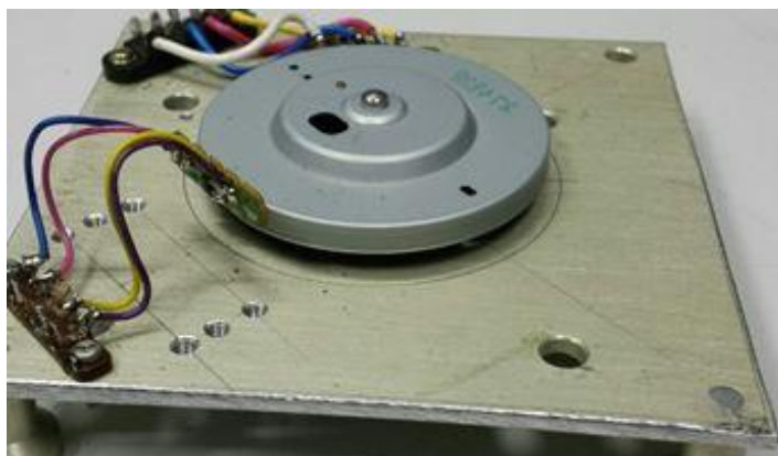
Рисунок 1. БДПТ от флоппи-дисковода
