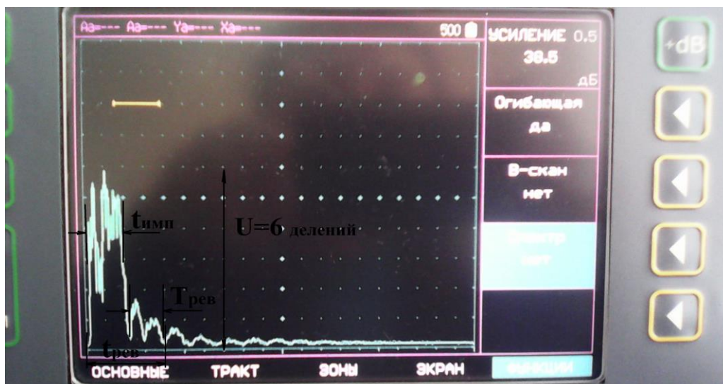
Рис. 3. Показания дефектоскопа: сигнал на месте «паста» с толщиной слоя 100 мкм
