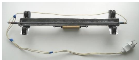
в) нагрев полосовым резистивным нагревателем мощностью 2 кВт, вручную перемещаемым вдоль поверхности объекта контроля
