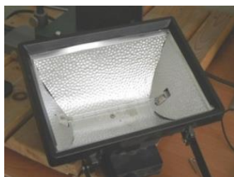
б) оптический нагрев галогенной лампой мощностью 500 Вт
