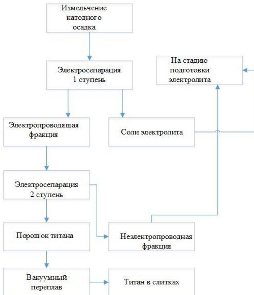
Рис1. Схема переработки катодного осадка.
