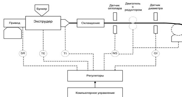
Рис. 5. Система контроля и управления мобильной экструзионной установкой
