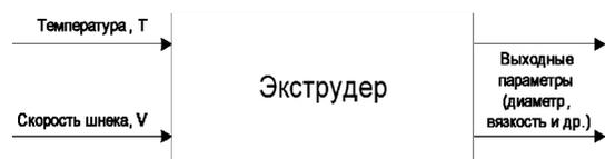
Рис. 4. Схема контролируемых параметров экструдера
