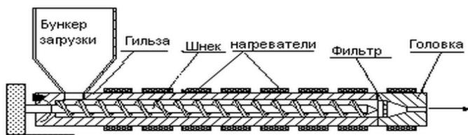
Рис. 1. Схема одношнекового экструдера
