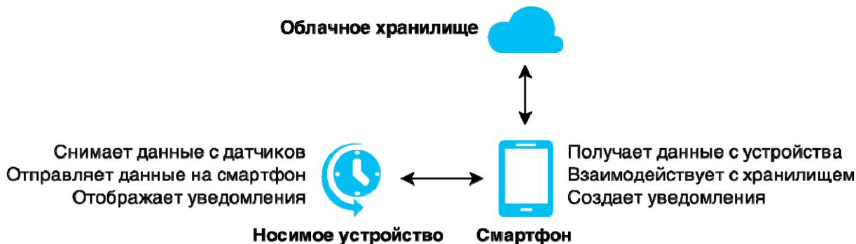
Рис. 1. Схема типового приложения для носимого устройства
