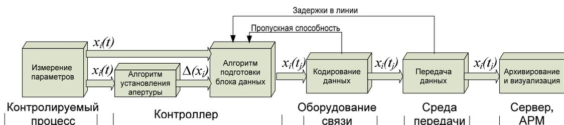
Рис. 1. Процесс спорадической передачи данных телеизмерений
