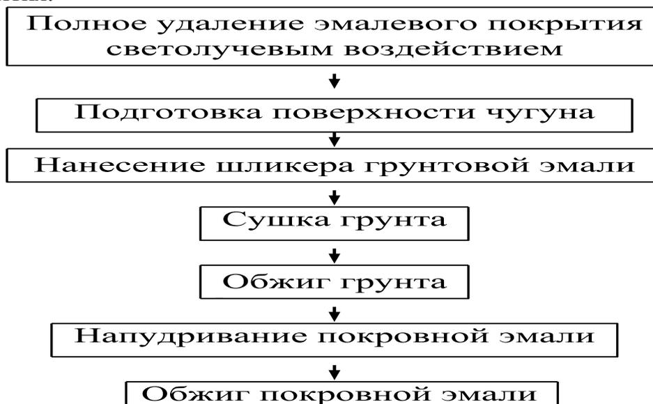
Рис. 13 Технологическая схема реэмалирования чугунных изделий с использованием светолучевого удаления дефектного покрытия
