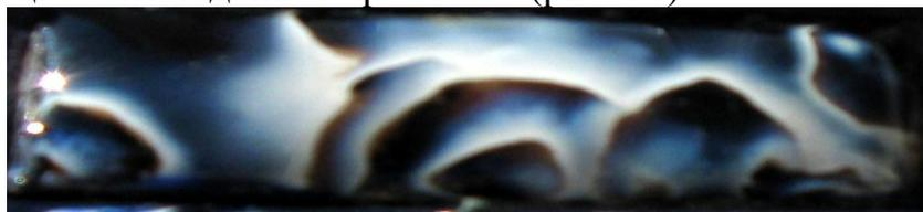
Рис. 11 Пластина. Эмаль ТК-17, подвергнутая многократному локальному проплавлению сфокусированным излучением ксеноновой короткодуговой лампы
