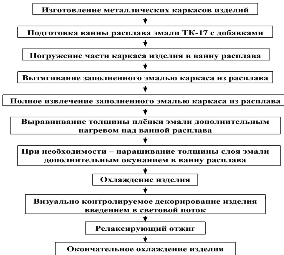
Рис. 16 Технологическая схема светолучевого изготовления изделий в технике «витражная эмаль» методом вытягивания изделия из расплава с последующим декорированием охлаждённого расплава в световом потоке
